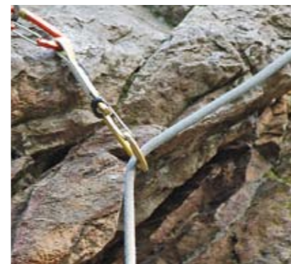
Die Bohrhaken für die Befestigung der Karabiner, durch die das Seil läuft.
